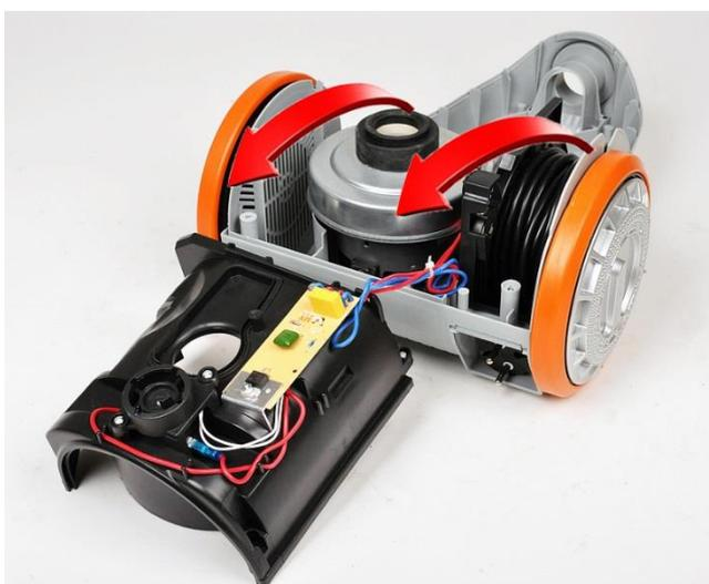
8. Entnehmen Sie die Kabelaufwicklung und die Motorgebläseeinheit.
