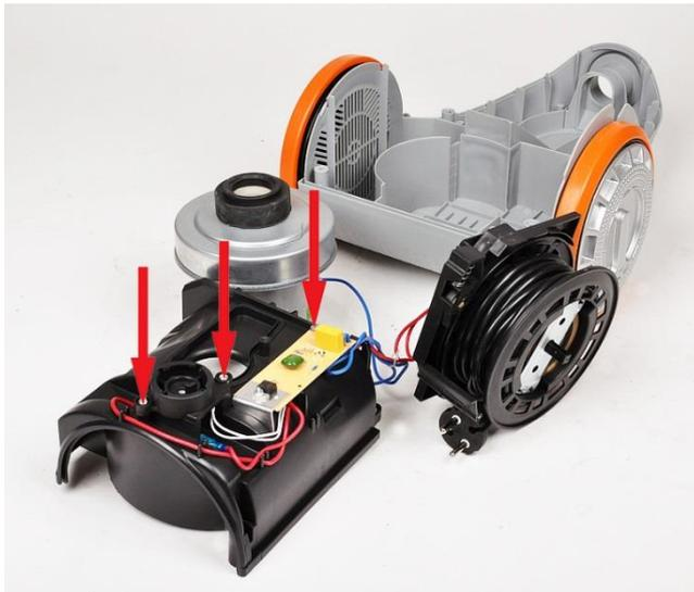
9. Die drei mit Pfeilen gekennzeichneten Schrauben lösen und den Schalter und die Leiterplatte entfernen.
