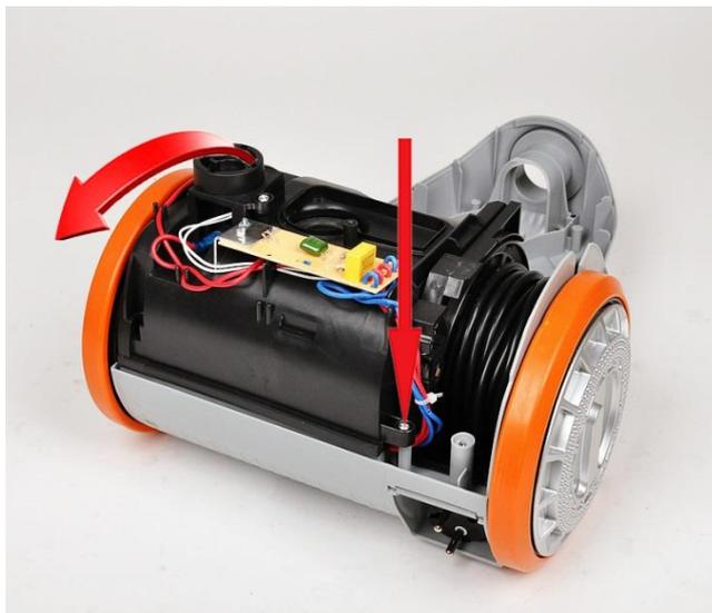
6. Die eine mit Pfeil gekennzeichnete Schraube lösen und entfernen.
