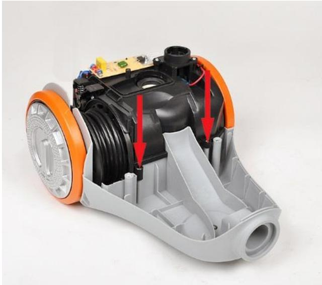
5. Die zwei mit Pfeilen gekennzeichneten Schrauben lösen und entfernen.
