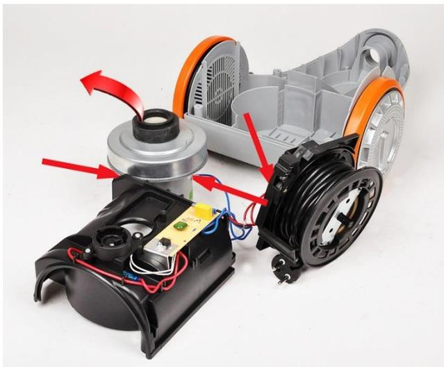
10. Entfernen Sie die Kabelflachsteckhülsen von der Kabelaufwicklung und von der Motorgebläseeinheit.
