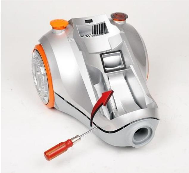
4. Gehen Sie mit einem Schraubendreher zwischen Gehäuseober- und unterteil und nehmen das Gehäuseoberteil ab.
